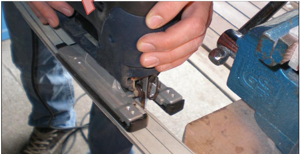
Image 45: Les branches peuvent également être découpés à l'aide d'une scie sauteuse.
